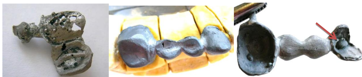
Figura 11. Defecte la nivelul scheletelor metalice turnate: pori, lipsuri parțiale, plusuri sferice.
