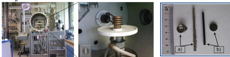
Figura 15. Cuptorul de retopire și turnare; probele experimentale de aliaje din sistemul Co-Cr-Mo-Ru.
