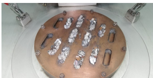
Fig. 4.2.1. Încălzirea metalică pe platoul din cupru în alveolele instalației RAV.
