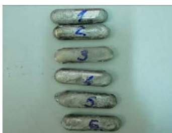
Fig. 4.2.2. Mini-lingouri din HEA FeMoTaTiZr.
