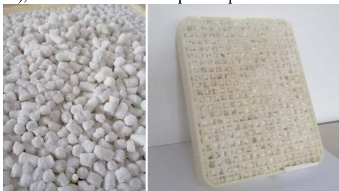
Fig. 1. Granule de saruri si sistem tip diafragma generatoare de aerosoli salini
